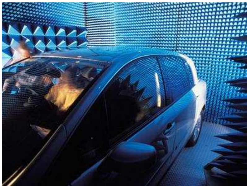
Figure 1. Illustration d'une salle servant de moyen de contrôle des ondes sonores : la chambre anéchoïde acoustique, ou chambre sourde. Cette salle est tapissée du sol au plafond de telle manière qu'aucun bruit extérieur ou écho ne puissent venir perturber les mesures visant à évaluer les niveaux sonores générés par les essuie-glaces du véhicule.
